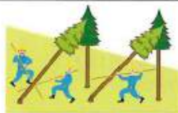
（図2）かかり木の処理
