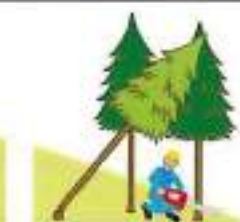
（図3）かかっている立木の伐倒
